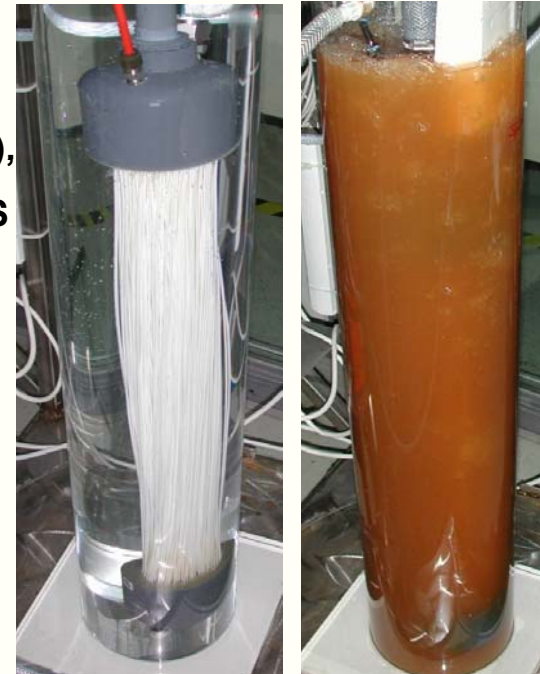
immersed membrane modules
